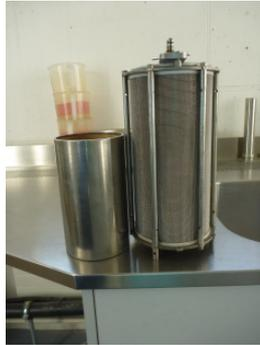
Wird das Bindemittel mit Toluol gelöst, steht eine Extraktionsanlage mit sechs parallelen Heizplatten zur Verfügung.
