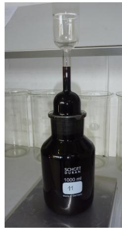
Die Rohdichte des Asphaltmischguts wird mittels Pyknometerverfahren bestimmt. Dazu wird das granuliert Mischgut ins Pyknometer gegeben und mit Lösungsmittel aufgefüllt, um das Bindemittel zu lösen. Nach Temperierung auf 25°C und ausschütteln aller Luftblasen wird das Pyknometer bis zur Eichung mit Lösungsmittel (mit bekannter Dichte) gefüllt. Durch Wägung kann nun die Rohdichte des Mischguts und durch Beziehung des löslichen Bindemittelgehalts auch die Gesteinsrohndichte ermittelt werden.
