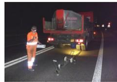
Um eine Aussage über die Tragfähigkeit und den Verstärkungsbedarf einer Strasse in Abhängigkeit vom Verkehrsaufkommen zu machen, sind zerstörungsfreie Deflektionsmessungen das geeignete Instrument.
