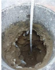
Bei Baugrunduntersuchungen besteht die Möglichkeit, mittels Schlitzsondierungen einen ausreichenden Aufschluss des Untergrundes zu erhalten.
