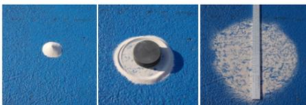
Beim Sandfleckversuch wird eine definierte Menge Sand auf der Oberfläche verteilt. Auf dem Spezialmassstab kann aus dem Durchmesser direkt die Texturtiefe abgelesen werden.
